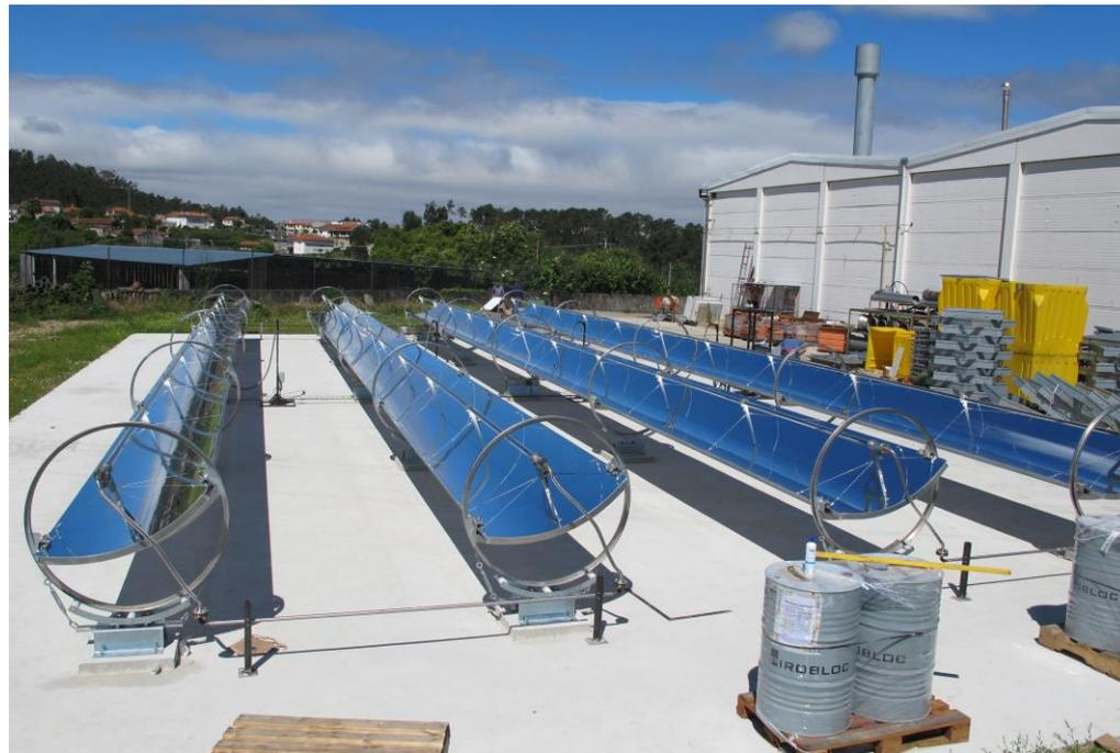
Concentradores Cilindro-Parabólico da Rackam instalados na Silampos – Projeto PRODUTECH PSI
